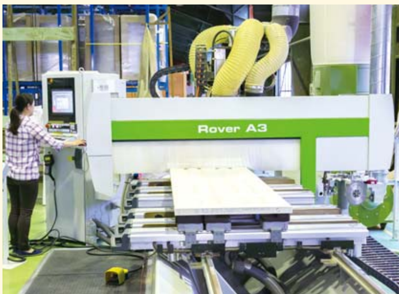
NCルーター (ドア加工)
