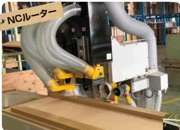
北米系を中心とした輸入建材は、現場での加工や塗装が一般的です。しかし、時代の流れと共に建築現場での工程管理、品質管理、施工性の向上をより厳しく求められるようになり、当社では木材製品の加工に適したNCルーターを導入し、加工済商品を現場にお届けする等お客様の作業効率の向上に貢献できるよう設備投資を進めてまいりました。
