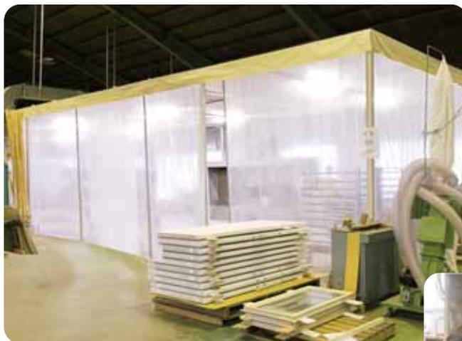
加工済だけでなく、塗装済商品の現場配送のご要望にもお応えするために塗装ブースを自社工場内に設置しました。ドア、窓、枠の塗装以外にも造作材等の塗装にも対応いたします。標準仕様の塗装からお客様のご要望に沿ったカスタム塗装まで承ります。
