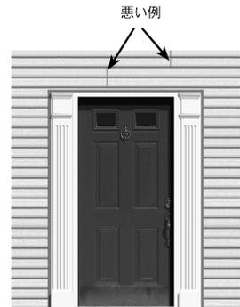
4. クロスヘッドなどの形状は不規則なため、それに合わせてフラッシングやサイディングを適切に切って、密着するようにはめ込むのは困難です。従って、クロスヘッドなどの部材は、裏面にPLプレミアム接着剤を塗って、サイディングの上に直接取付け、非腐食性留め金具でしっかりと固定します。クロスヘッドの後ろに浸透した水分は、ステップ3で取付けたJ型溝付きモールディングを伝わって流れ出ます。
