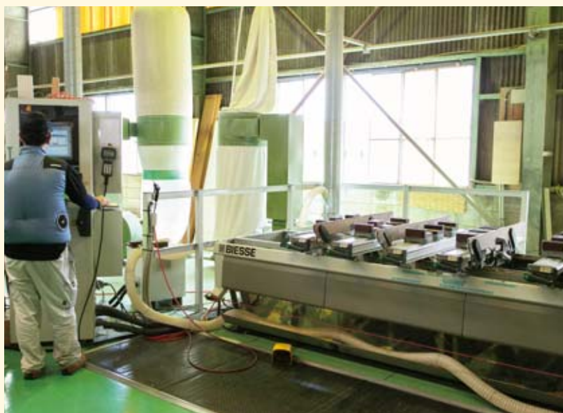
NCルーター(ドア加工)
