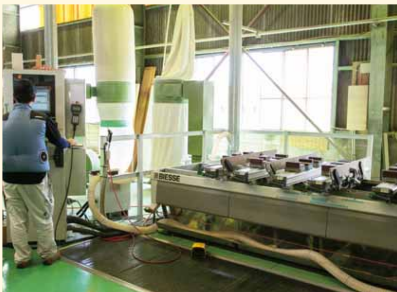
NCルーター (ドア加工)
