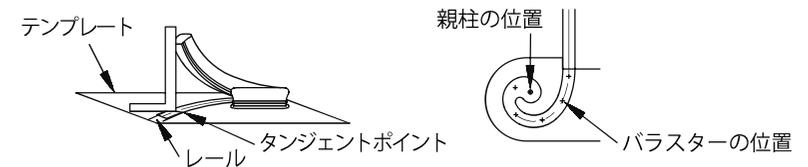
平らな面で、テンプレートにボリュートを並べます。タンジェントポイントをテンプレートに写します。次に、タンジェントポイントの線に垂直なテンプレートにレールを描画します。テンプレートをスターティングステップのトレッドに配置し、レールと位置合わせて、スターティングステップのブルノーズの中央に配置されていることを確認します。トレッドのバラスターと親柱の位置をマークします。
