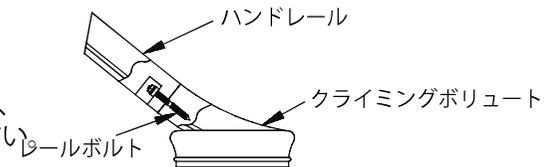
ハンドレールとボリュートを階段に配置し、ボリュートをスターティングステップの中央に配置します。木のブロックを使用して、トレッドのバラスターと親柱のマークをボリュートに写します。
