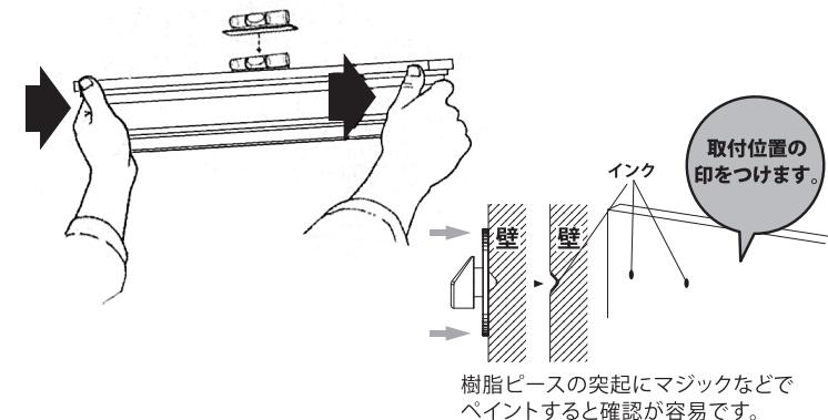
④ 樹脂ピースを金具から外し、ピースの穴(樹脂ピースの突起で付いた目印位置)に付属の釘をハンマーなどで打ち込んでください。
