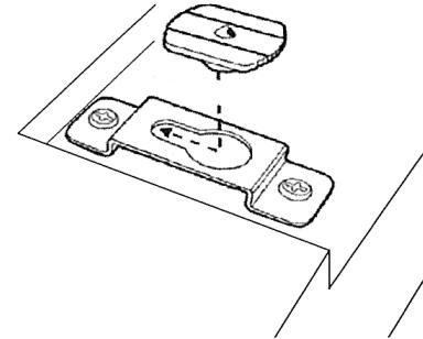
③ 樹脂ピースをセットしたシェルフを水平器を使い傾きを調整し、壁に強く押し付けて樹脂ピースの突起で壁に目印を付けます。
