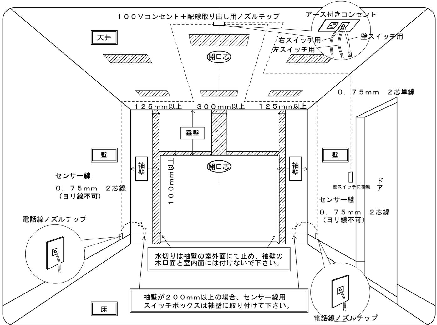
垂壁、袖壁の三方壁は、天井から仕上げ土間まで段差なく仕上げてください。
