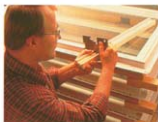
歪みの検査。 精密に作られた窓が生産されています。
